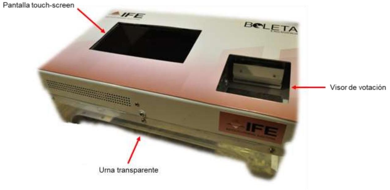
**Elementos del panel de controles que sólo son accesibles para el operador de la boleta electrónica (BE)**
