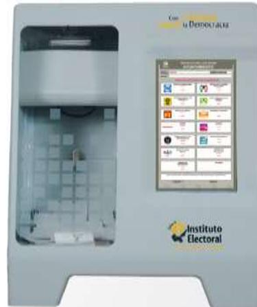
La o el PMDC se asegurará que la urna muestre el mensaje “*En espera de elector*” para que pase la o el siguiente elector en la pantalla trasera (**punto 2**); la urna electrónica quedará inhabilitada hasta que se vuelva a digitar el código de votación.
